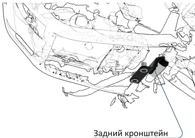
2. Придерживая кронштейн установить и зафиксировать защиту используя винты из комплекта. Установить передние кронштейны, зацепив их за раму
