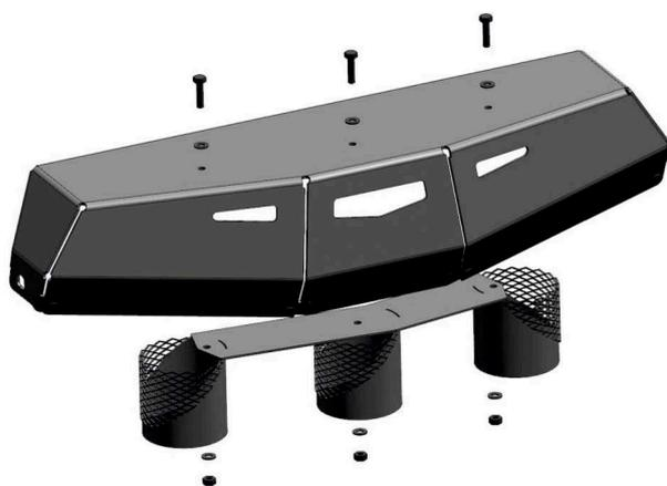
12. Установить патрубки поз.1 на панель (отмечена цифрой 1 в пункте 11), крепить винтами М5х20 поз.15, гайками М5 поз.19 через шайбы 5 поз.22. Закрепить воздуховоды D63 поз. 2,3,4 на патрубках хомутами черв.60-80 поз.11. Установить панель обратно на вынос радиатора. При необходимости уменьшить длину воздуховодов: их длина должна обеспечивать полную регулировку угла наклона выноса радиатора.
