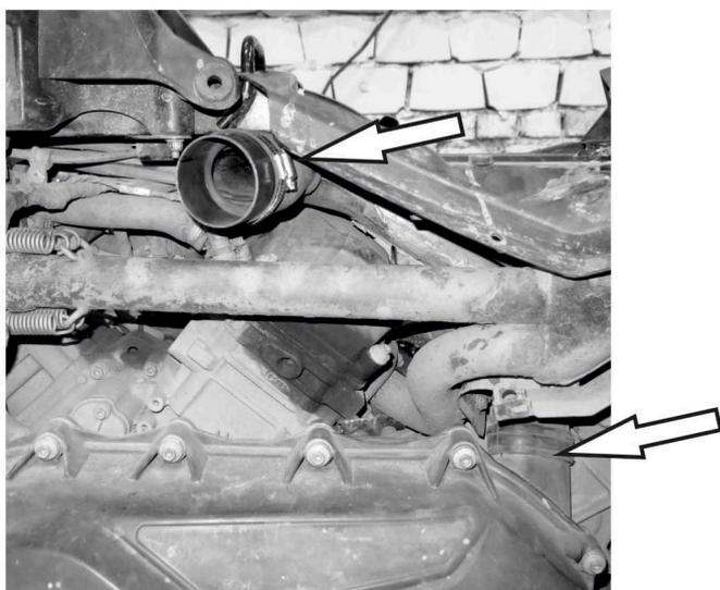
5. На овальный выход вариатора установить силиконовый переходник D70/D63 поз.12, закрепить червячным хомутом 60-80 поз.11. Вставить в переходник патрубок D63 поз.9 закрепить хомутом 60-80 поз. 11. На патрубок D63 закрепить воздуховод D63 поз. 2 хомутом 60-80. Для удобства установки допускается снятие штатного пластикового воздуховода и металлического отражающего экрана. На круглый выход вариатора установить воздуховод D63, закрепить хомутом 60-80 поз.11
