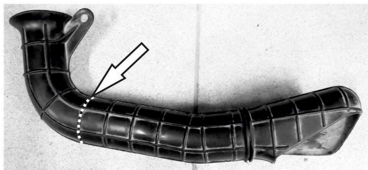
9. Отрезать часть от резинового патрубка воздушного фильтра по линии(на фотографии патрубок снят для наглядности). Вставить переходник D45/D63 поз.7 в резиновый патрубок. Установить воздуховод D63 поз.4 на переходник. Закрепить соединения червячными хомутами 40-60 мм поз.13 и хомутами 60-80 поз.11. **ВАЖНО! Все соединения промазать силиконовым или полиуретановым герметиком**
