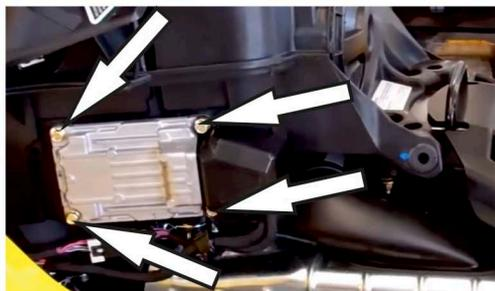
2. Снять ЭБУ со штатных мест. Установить кронштейны ЭБУ поз. 5 и 6 в штатные места крепления ЭБУ, крепить винтами М6х16 поз.16 через шайбы 6 поз.23. Установить ЭБУ на кронштейны, крепить винтами М6х20 поз.17 через шайбы 6 поз. 23 и 24. Закрепить жгуты проводов на кронштейне ЭБУ пластиковыми стяжками поз.10.
