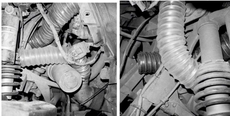
7. Установить воздуховод D63 на пластиковый патрубок входа вариатора из п.3, закрепить червячным хомутом 60-80 поз.11. Провести в подкапотное пространство установленные воздуховоды. Закрепить патрубки и жгуты проводов пластиковыми стяжками к квадроциклу. **ВАЖНО! Все соединения промазать силиконовым или полиуретановым герметиком**
