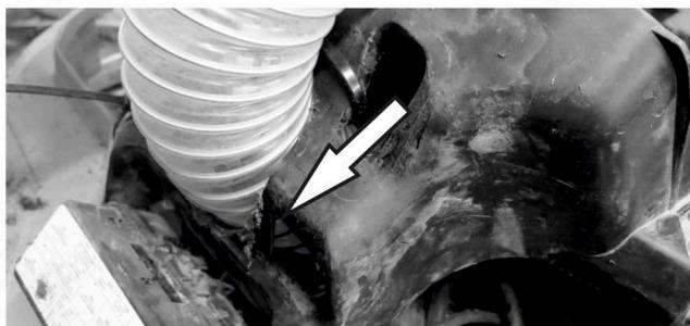
10. Просверлить отверстие диаметром 70 мм в пластиковой накладке панели приборов и в пластиковом каркасе панели приборов. При необходимости расширить вырез в ручную. Не допускается повреждение крепления пластиковой наклейки (обозначено стрелкой)
