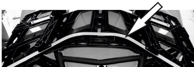
8. Просверлить два отверстия для выхода воздуховодов диаметром 70мм в багажнике и капоте, не задев металлический каркас багажника(отмечен стрелкой).
