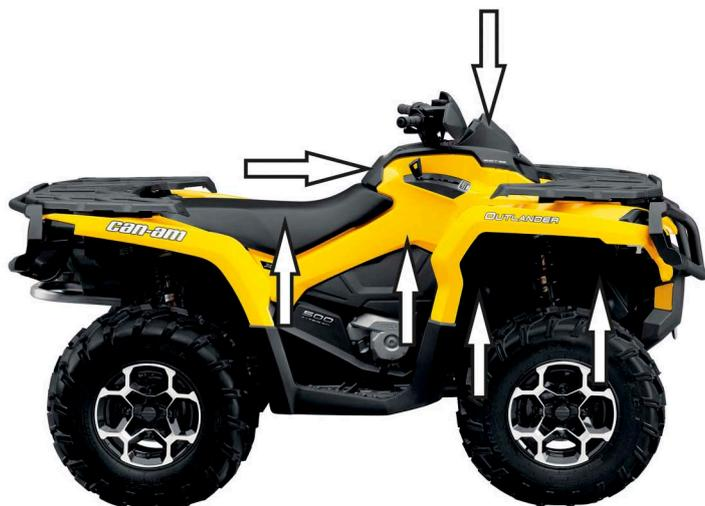
1. Снять пластиковые подкрылки с обеих сторон. Снять сидение, пластиковую накладку на воздушном фильтре, пластиковую накладку на панель приборов. Пластиковые панели с обеих сторон от сидения. Для демонтажа пистонов рекомендуется использовать специальный съемник
