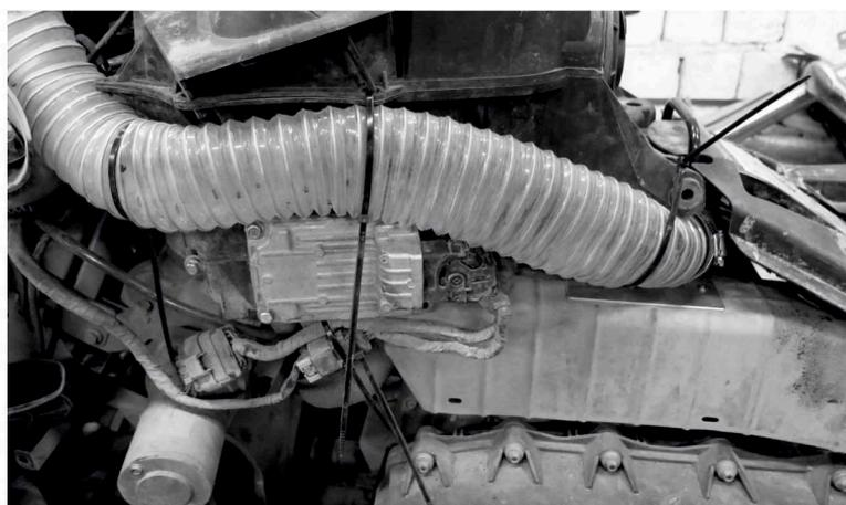
6. Провести воздуховод вдоль квадроцикла, сплющивая его в местах соприкосновения с пластиковой обшивкой. Закрепить воздуховод стяжками.
