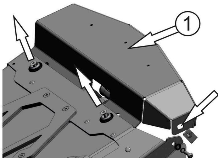
11. Открутить на 3-4 оборота верхние винты крепления радиатора к выносу арт. 444.7241.1, винты М6 крепления панели к выносу по бокам. Снять панель (отмечена цифрой 1).
